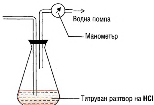
Фиг. 8. Апарат за вземане на определен обем въздух за определяне на съдържанието на амоняк в него
